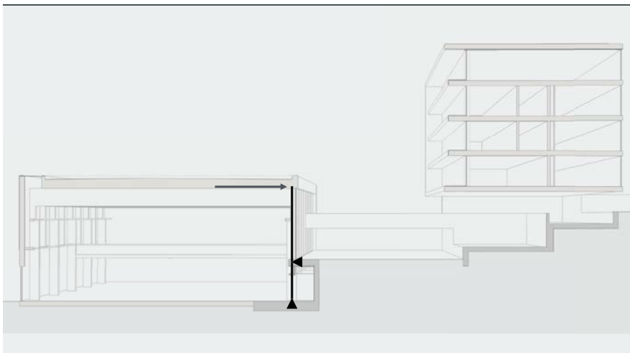
Die 20 cm breiten und 68 cm tiefen Hauptstützen sind auf der Hangseite im unteren Drittel in die betonierte Stützwand eingespannt und sorgen damit u.a. für die Queraussteifung der Halle.
